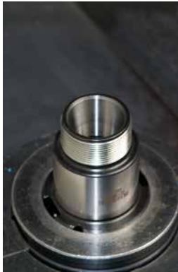
Remove nut from ER holder
