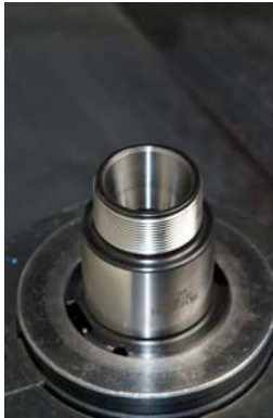
Remove nut from ER holder
