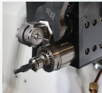
5 Use ER wrench to fasten the ER nut on the holder.
