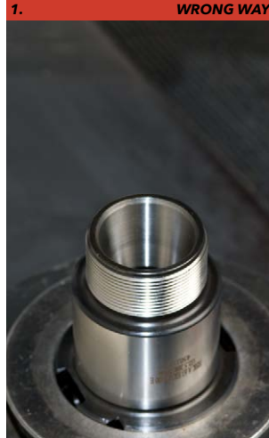
1. Remove nut from ER holder.
