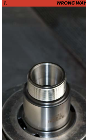
1. Remove nut from ER holder.
