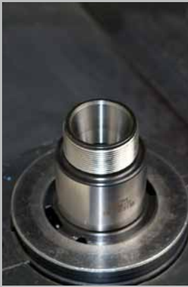
Remove nut from ER holder
